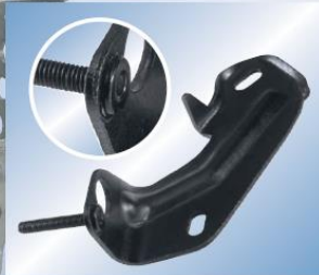
Halter – Stanz-/Biegeteil mit Buckelschweiß-Schraube – Oberfläche KTL
