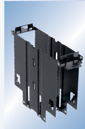
Halter Funk – bestehend aus 3 Einzelplatten – verschraubt / vernietet, lackiert – eingeklebte Schutzgummileisten
