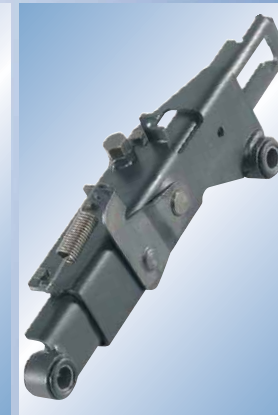
Strebe – komplett im Haus gefertigt (Gummibuchsen und Federn beige stellt)
