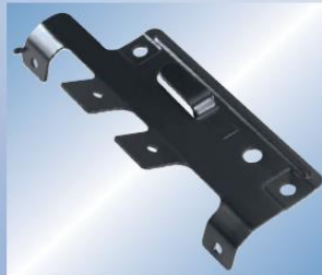
Befestigungswinkel - Material DC01 2mm - Stanz-/Biegeteil - pulverbeschichtet /KTL
