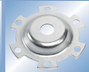
Lüfterrad - Ziehteil aus DC03 3mm - verzinkt
