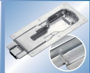
Griffschale – tiefgezogen, punktgeschweißt – verzinkt
