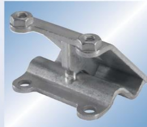
Crash-Fanghaken – 3 Platinen – Handschweißung MAG – mit Buckelschweißmuttern
