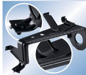
Halter VLP – aus 2 Platinen punkt- und buckelgeschweißt
